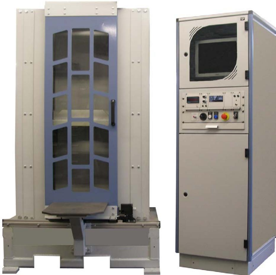
**Vollautomatisches Federprüfgerät AFK 11 mit Servomotorsteuerung.
