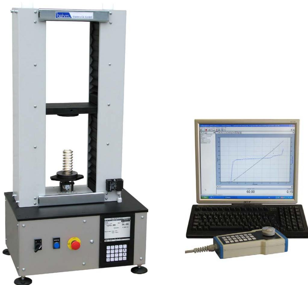
**Vollautomatisches Federprüfgerät AFP7-D für dynamische Messung.
