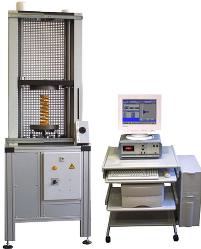
**Vollautomatisches Federprüfgerät AFK 8 K
