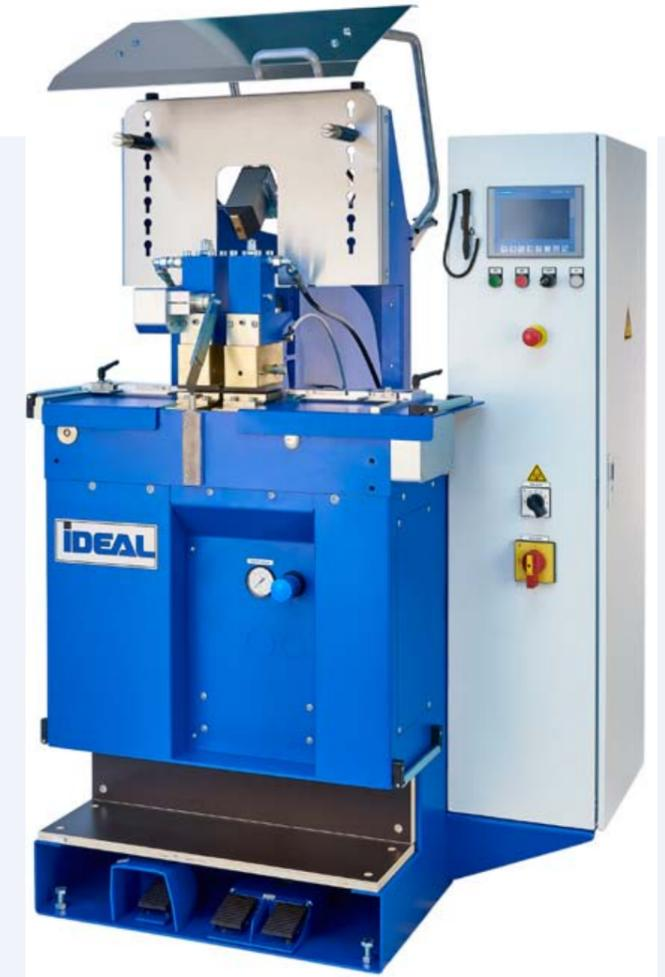
BAS 300 Abbrennstumpf-Schweißmaschine für die Serienkonfektionierung von Bandsägen
