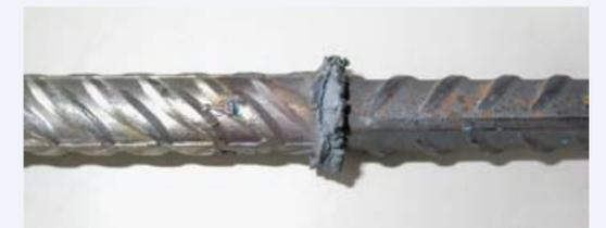
Abbrennstumpf-Schweißung von Betonstahl
