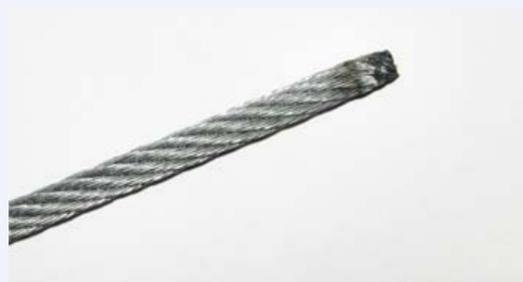
durch Separieren mit Drehung verschmolzenes, verjüngtes Drahtseilende
