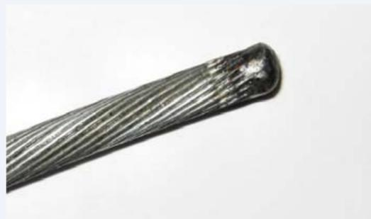
durch Separieren verschmolzenes Drahtseilende
